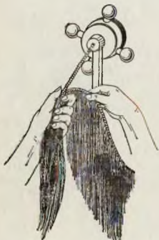
Рис. 40. Прием накручивания треса на жгут из тесьмы при изготовлении косы
