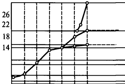
Рис. 3.3. Динамика роста световой отдачи ЛН, приведенной к лампе мощностью 100 Вт со сроком службы 1000 ч: I — угольная нить в вакууме; II — тянутая вольфрамовая нить в вакууме; III — вольфрамовая моноспираль в вакууме; IV — вольфрамовая биспираль в аргоне и криптоне (прогресс в технологии и оборудовании); V — применение галогенного цикла и кварцевых оболочек; VI — применение теплоотражающих покрытий на колбах и иных новых физических процессов и технических решений
