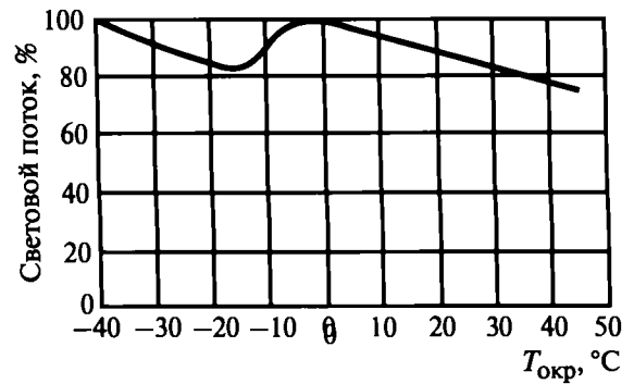
Рис. 3.97. Зависимость светового потока БИЛ типа QL от температуры окружающего воздуха
