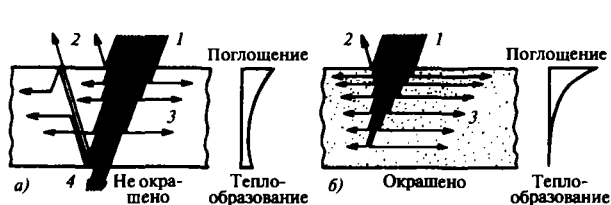
Рис. 16.2. Теплообразование внутри облучаемого однослойного тела при слабом (а) и сильном (б) поглощении: 1 — падающее излучение; 2 — отраженное излучение; 3 — поглощенное излучение; 4 — пропущенное излучение
