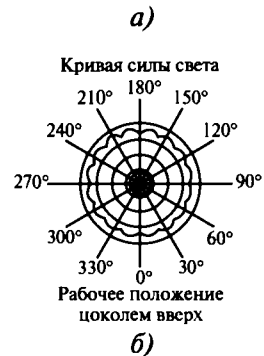
Рис. 3.53. Восьмиканальная амальгамная КЛЛ: а — общий вид; б — КСС в поперечной плоскости
