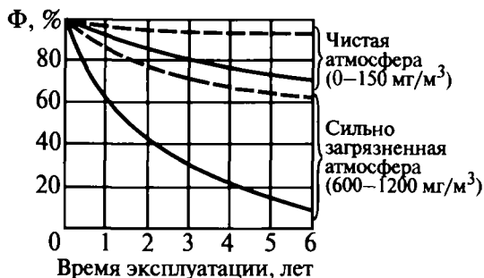
Рис. 6.13. Потери светового потока от запыления в открытых (—) и закрытых (---) СП для улиц
