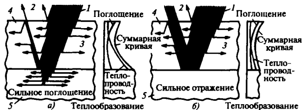
Рис. 16.3. Теплообразование внутри облучаемого двухслойного тела при сильно (а) или слабо (б) поглощающей подложке: 1 — падающее излучение; 2 — отраженное излучение; 3 — поглощенное излучение; 4 — слой лака; 5 — подложка
