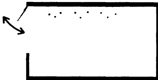
Рис. 18.45. Экспериментальная установка на фасаде университета в Дортмунде (ФРГ). Светонаправляющая система с применением голографической пленки на обычных солнцезащитных устройствах
