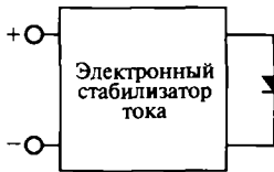
Рис. 4.35. Схема включения СД в сеть постоянного тока через электронный стабилизатор
