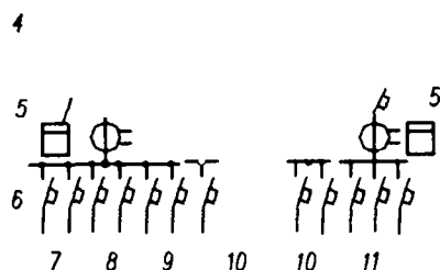
Рис. 9.17. Схема ВРУ жилого дома высотой 17 и более этажей: 1 — ввод № 1 от ТП; 2 — ввод № 2 от ТП; 3 — граница раздела с электроснабжающей организацией; 4 — станция АВР; 5 — расчетный счетчик электроэнергии; 6 — щиток домоуправления; 7 — линии АО общедомовых помещений; 8 — распределительные линии систем дымозащиты; 9 — распределительные линии лифтов; 10 — распределительные линии квартир; 11 — линии рабочего освещения общедомовых помещений
