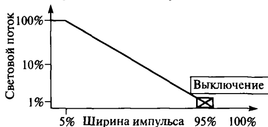
Рис. 4.53. Регулировочная характеристика ПРА при ШИМ управлении
