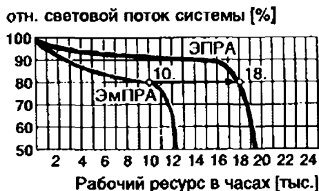
Рис. 4.14. Кривые спада светового потока ЛЛ при работе с ЭМПРА и ЭПРА
