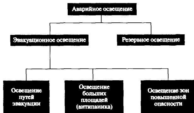
Рис. 10.3. Классификация видов аварийного освещения
