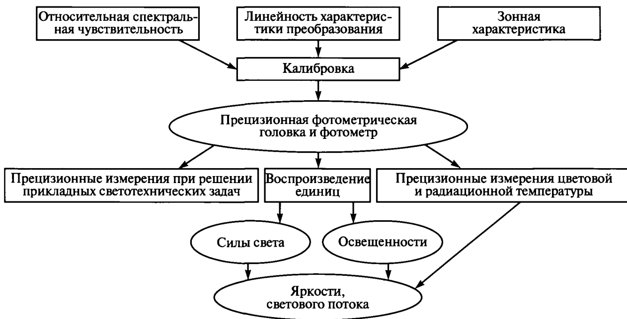
Рис. 2.2. Фотометрические измерительные задачи
